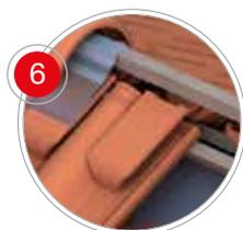
El rastrel que se instala en la cumbrera irá fijado sobre los Soportes de Rastrel. Para su instalación, se deberán fijar al soporte con la pendiente y altura necesarias, de forma que los caballetes queden directamente apoyados sobre las tejas de la última hilada y las cuñas de caballete.
