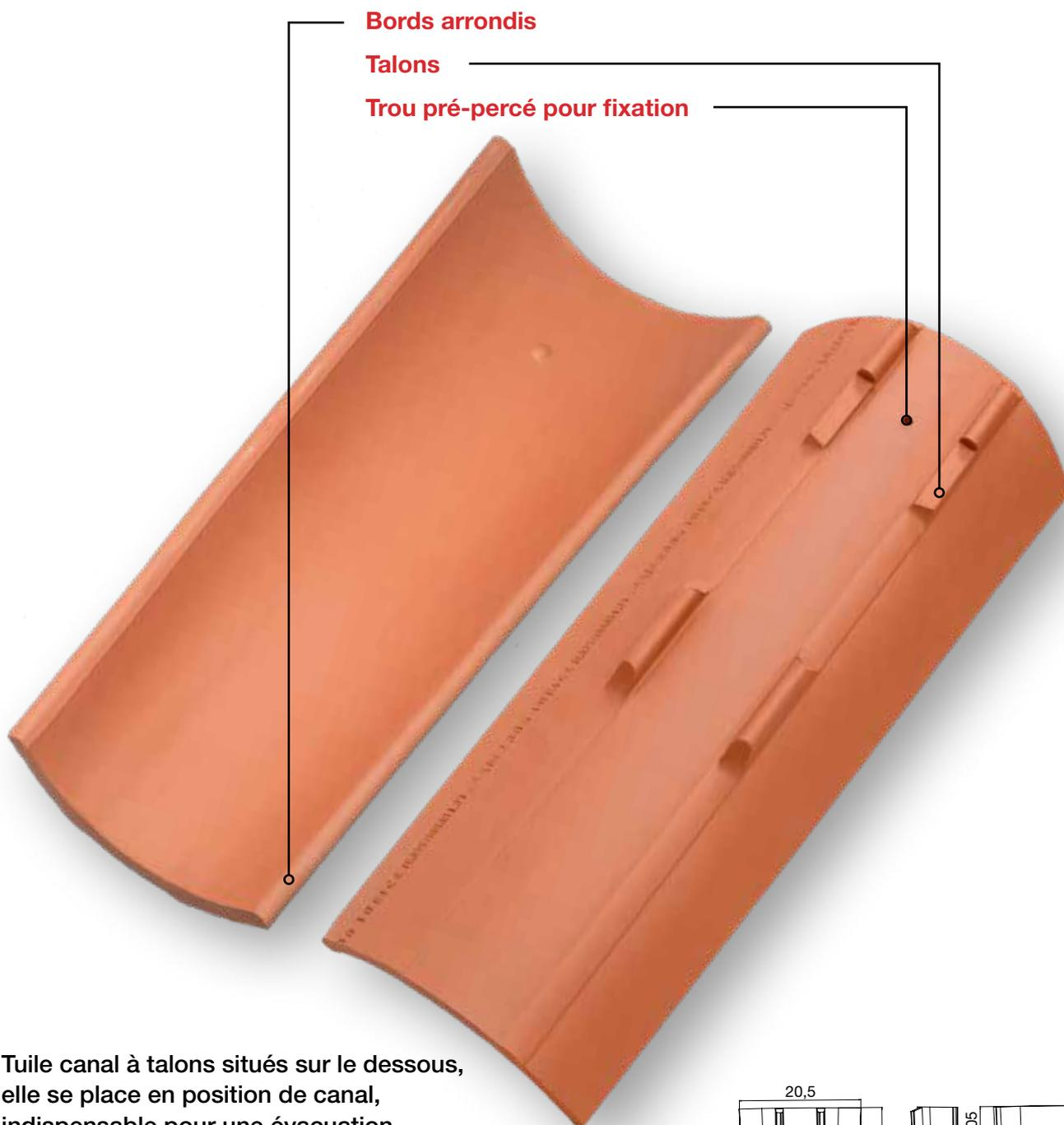
**Tuile canal à talons situés sur le dessous, elle se place en position de canal, indispensable pour une évacuation efficace de l'eau sur les toitures. Compatible avec les tuiles canal C-50.21 Celler® et C-45.20, installées par pose à sec sur liteaux.**
