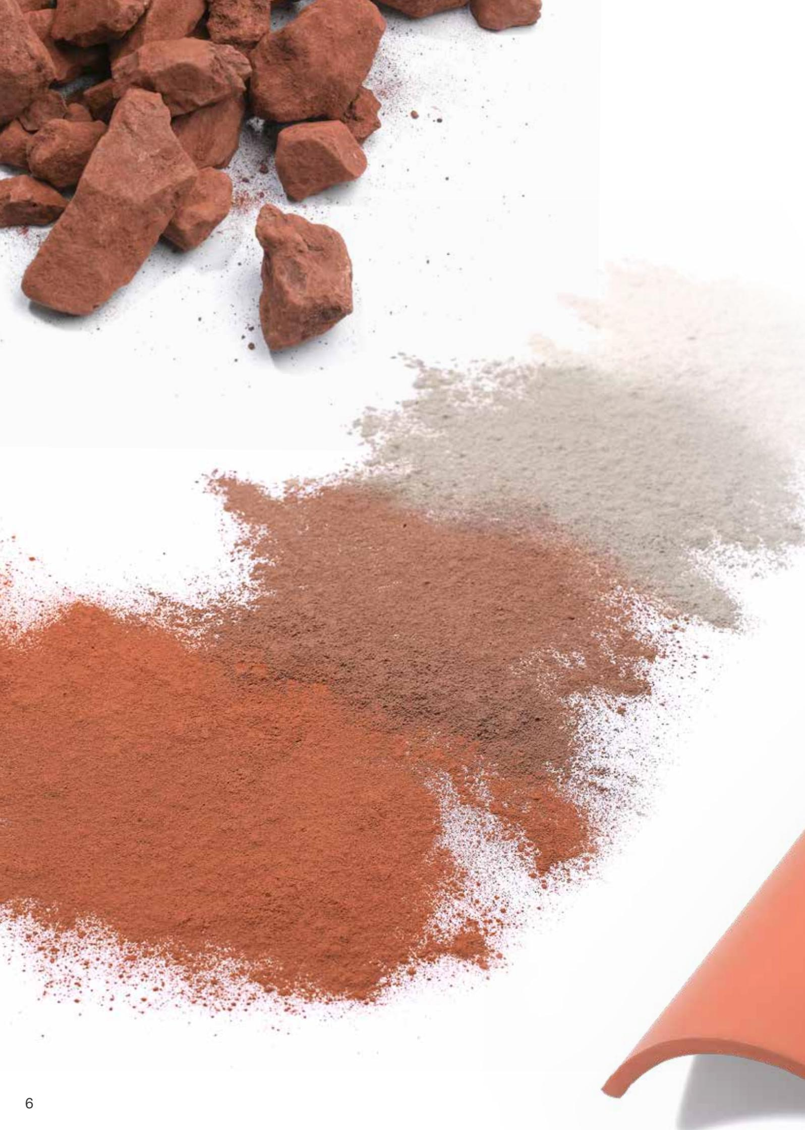
L'élection de la matière première revêt une importance capitale qui se répercutera sur la qualité du produit final. Les tuiles Tejas Borja se caractérisent par leur argile fine et de haute qualité. La sélection méticuleuse de l'argile permet d'optimiser les propriétés techniques des tuiles, tant en termes de résistance que de stabilité dimensionnelle. Grâce au procédé de fabrication, nous obtenons des tuiles canal céramiques haute qualité dans des formats, couleurs et textures variés.
