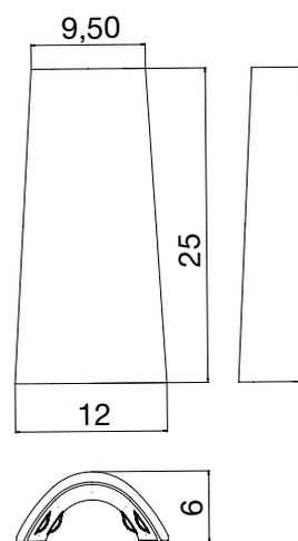
**Valeurs approximatives:** Il sera nécessaire de déterminer le pureau utile sur chantier. L'imperméabilisation de la surface du support sur toutes les pentes sera nécessaire. L'installation doit respecter les indications du DTU en vigueur et les spécifications techniques de Tejas Borja.
