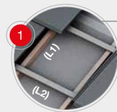
Sur le support de la toiture, il faudra poser une membrane imperméable respirante, puis installer les liteaux principaux tous les 50/70 cm, parallèlement à la ligne de pente maximale (L1). Les liteaux horizontaux d'appui pour les tuiles (L2) seront fixés selon la longueur utile de chaque modèle de tuile (il faudra vérifier sur le site le respect de la norme DTU en vigueur).
