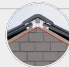
Sur le liteau de faîtage, on posera le sous-faîtage (Mixte, Aluminium ou Rigide), en le fixant avec des agrafes ou des clous. Les rouleaux disposent d'une bande adhésive à base de butyle qu'il faudra fixer sur le profil des tuiles afin d'imperméabiliser la liaison.
