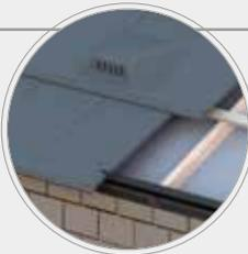
Para evitar la entrada de pájaros al tejado y permitir la ventilación se instalarán Peines de Alero. El primer rastrel que se instala sobre los aleros, debe tener una altura 2 cm superior al resto, para ello se puede instalar en esta zona un rastrel de mayor altura o utilizar el Rastrel + Peine de Alero, que combina ambos productos. En caso de la teja Flat 12, hay pieza de Arranque disponible en el catálogo para cumplir esta función.
